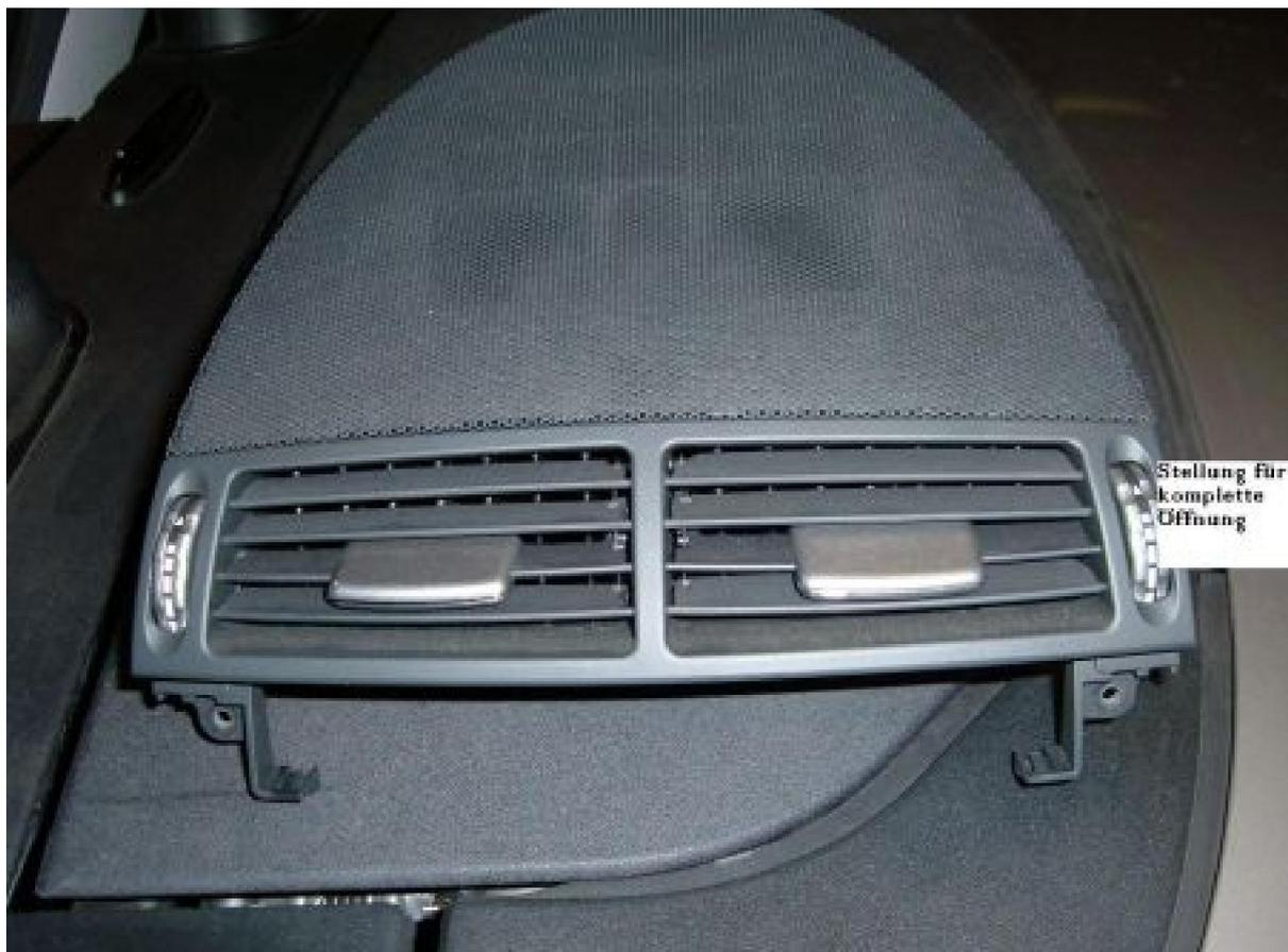
Wie auf Foto 1 oben zu erkennen ist werden die seitlichen Belüftungen jeweils neben dem Radio mit der Luft aus den Mitteldüsenkanal versorgt.
