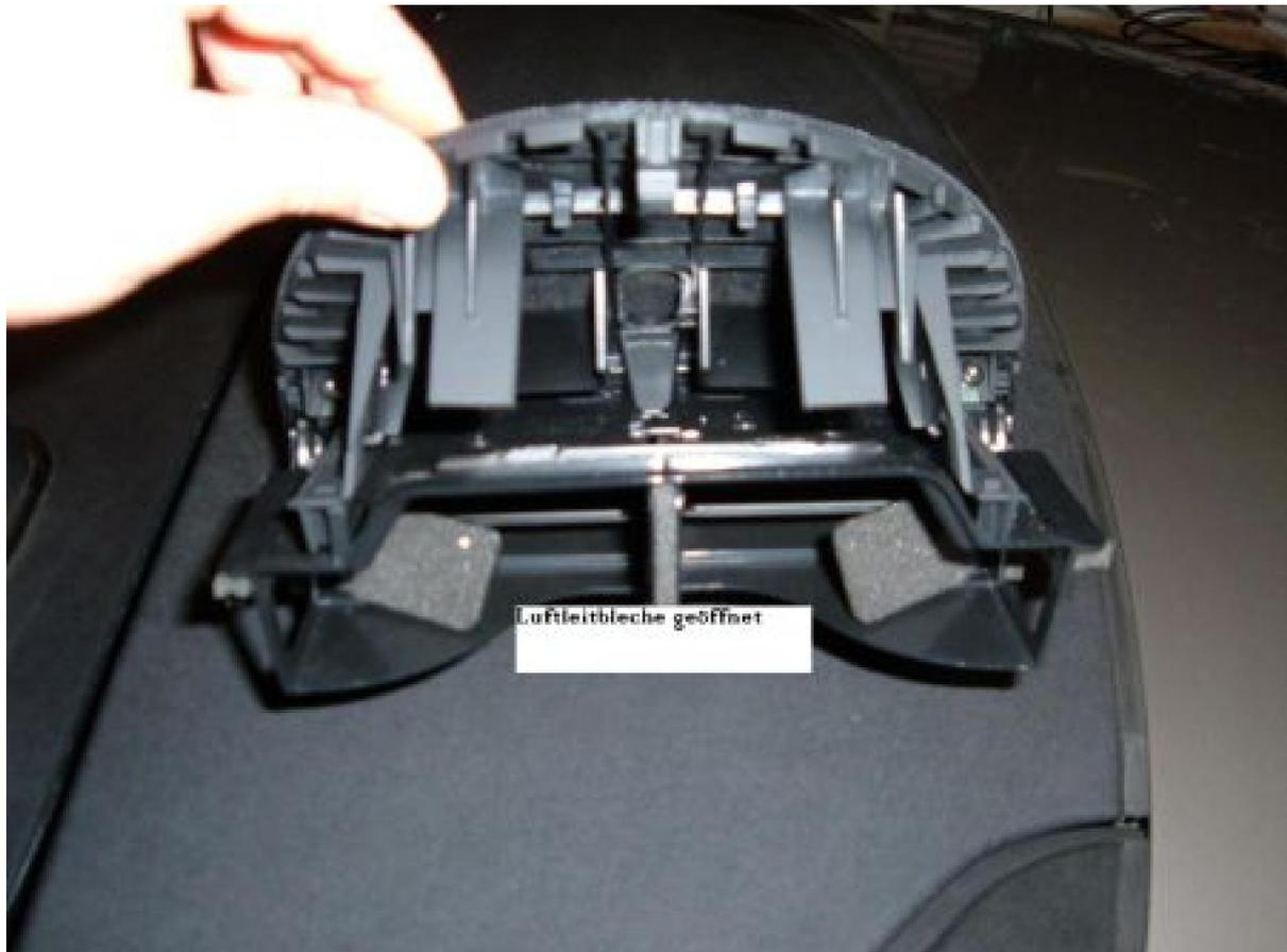
durch verdrehen der vorderen Stellräder klappen diese dann auf und zu und versperren dann die Luftzufuhr zu den seitlichen Festdüsen
