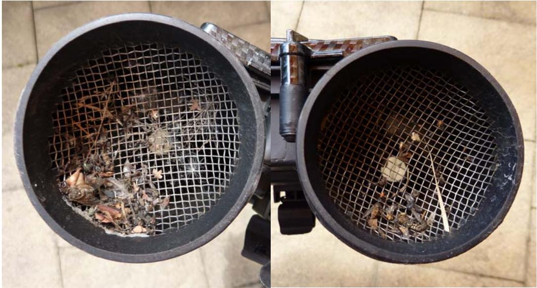
Bei der Gelegenheit die Luftfilter und die Siebe (sofern vorhanden) prüfen und ggf. austauschen/reinigen
