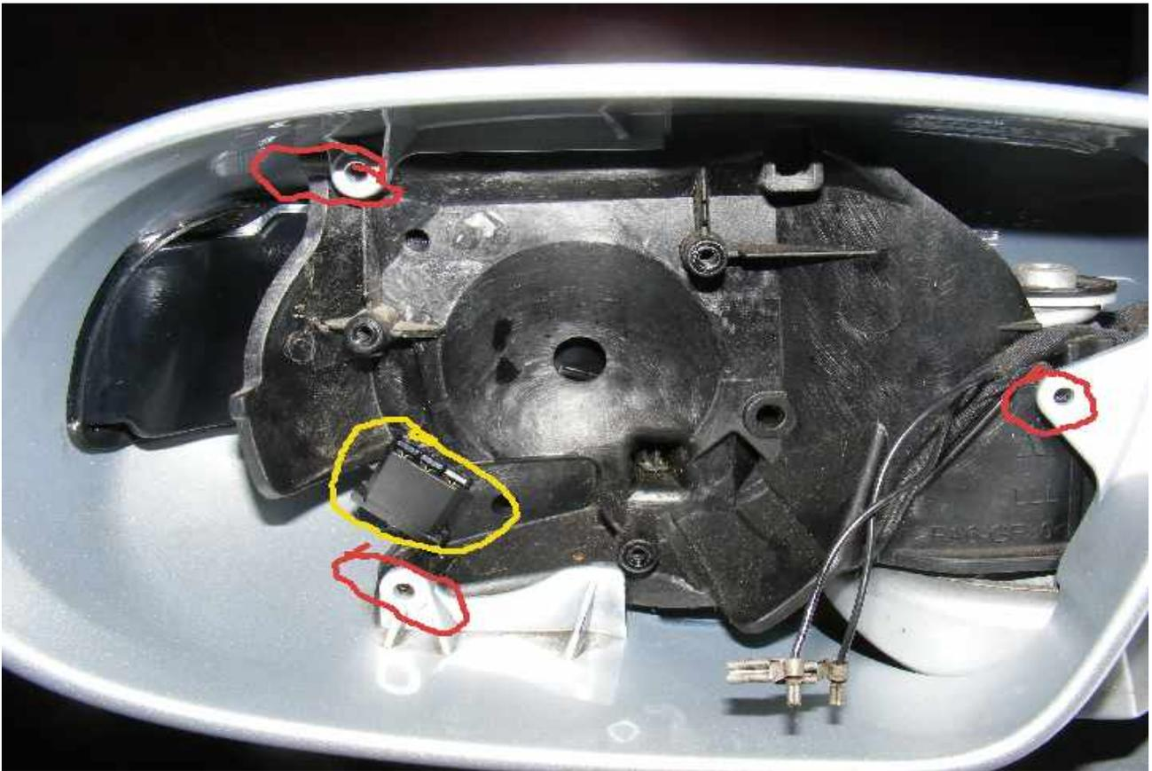
Dann die 3 rot markierten Schrauben lösen und das Spiegelgehäuse abziehen.
