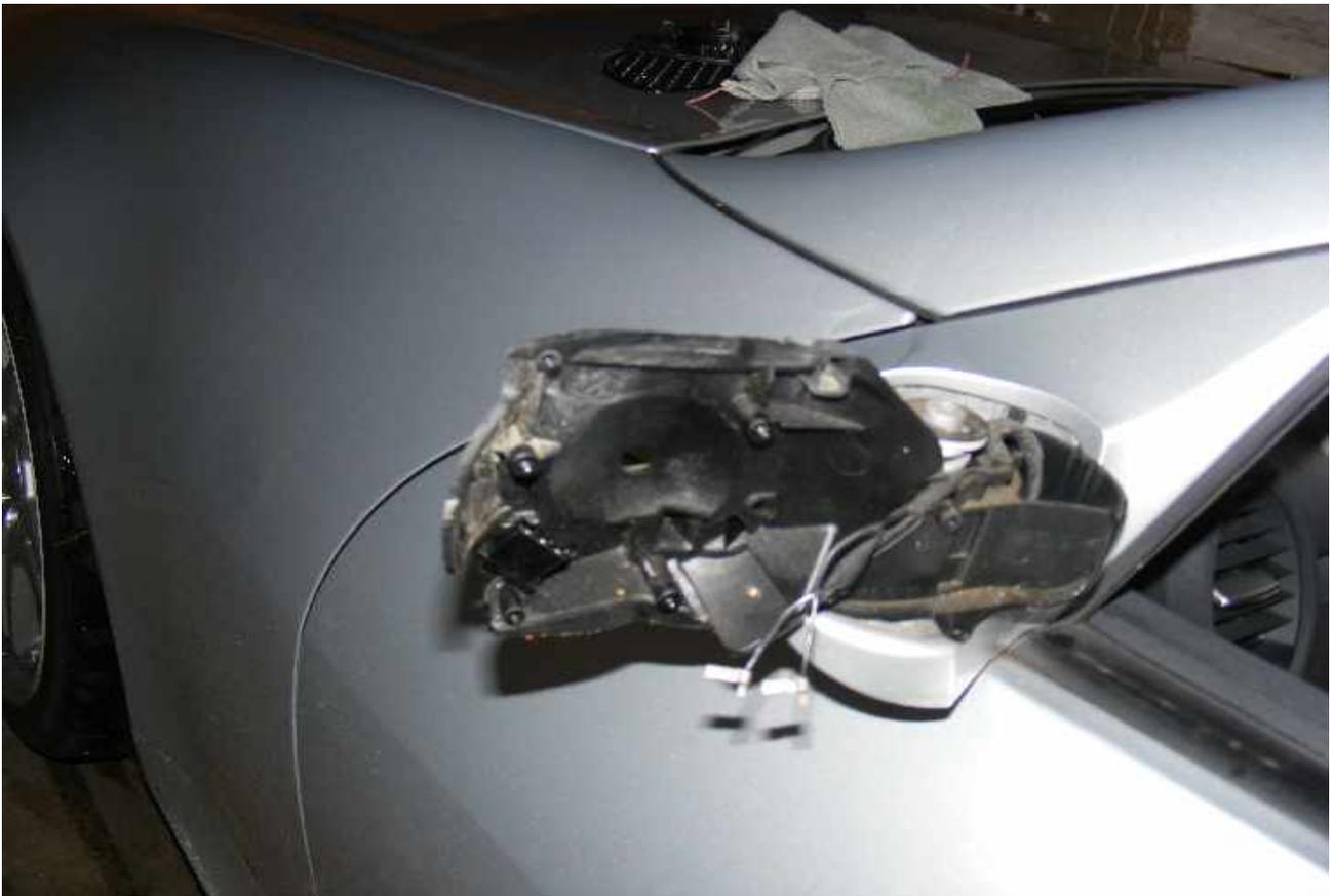
Jetzt noch die zwei Schrauben vom Blinker herausdrehen und den Blinker komplett tauschen.
