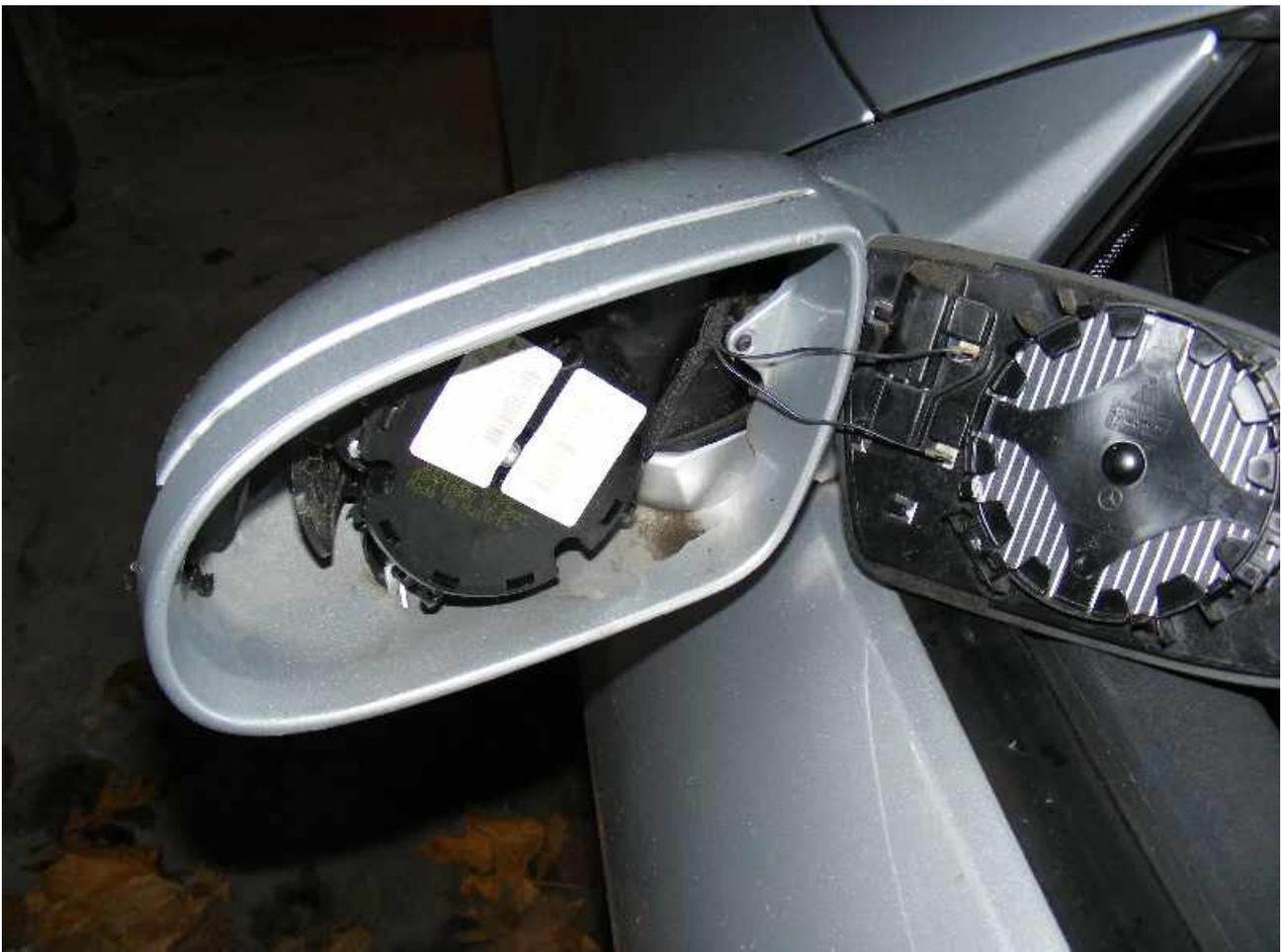
Als nächstes werden die beiden Kabel abgezogen. Bei mir ging das erst nachdem ich etwas WD 40 aufgesprüht hatte. Also ein Rostlöser als Hilfe sollte vielleicht parat stehen ;-)
