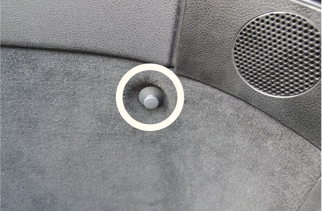
Dann den Kantenschutz links und rechts abziehen und den Teppich aus den Klammern ziehen und nach vorn klappen.
