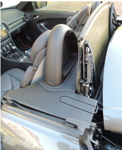
(Dachschließung einleiten und anhalten bevor das Dach heraus fährt).
