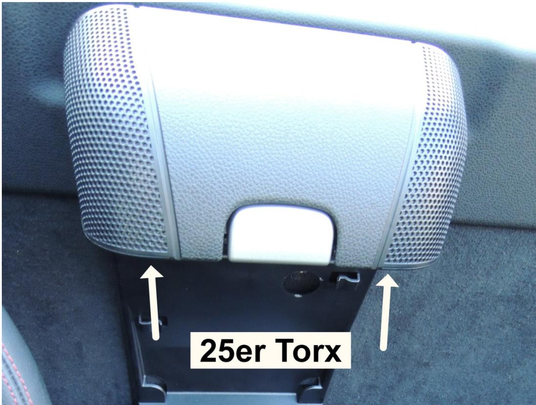
Anschließend das Rückteil des Staufaches durch Herausdrehen der zwei 6-Kant Schrauben entfernen.
