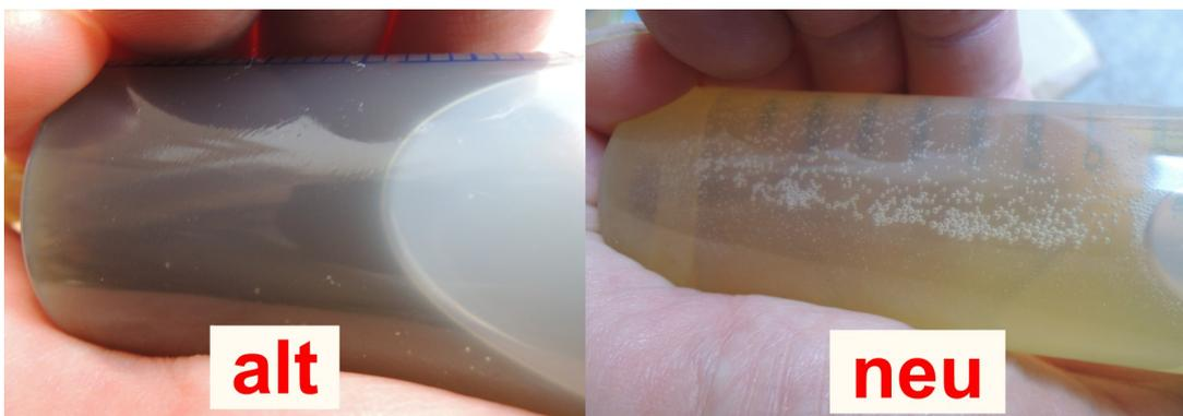
Der Füllstand der letzten Füllung muß bis an das Pluszeichen im oberen viertel des Ölbehälters reichen. Das sind ca. 110 ml, die bei leerem Tank einzufüllen sind.
