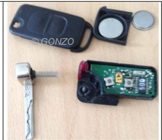
5.) Drehfeder und Kunststoffbetätigungs-knopf mit Tesafilm o.ä. am Schlüsselbart befestigen.
