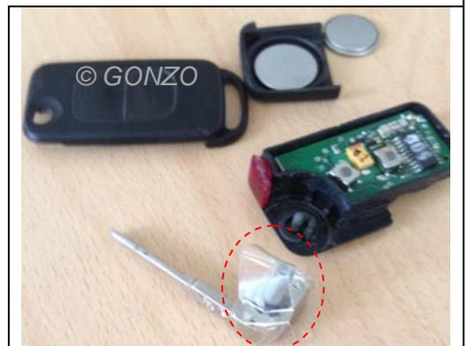
6.) Platine entnehmen (liegt nur lose im Schlüsselgehäuse) und den defekten SMD-Taster austauschen.
