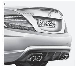
AMG Heckschürze, Abrisskante und Sport-Abgasanlage
