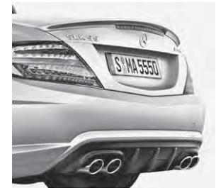
AMG Heckschürze, Abrisskante und Sport-Abgasanlage
