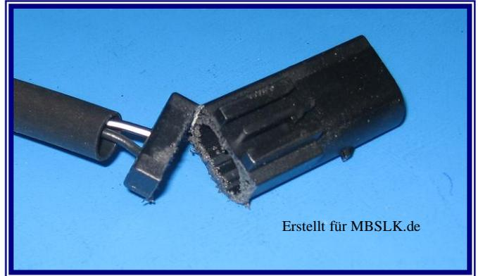
2. Beide Kabelende auf gleiche Länge schneiden, ca. 7mm abisolieren und verzinnen
