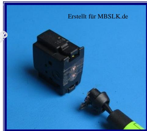
6. Beide Kabelende auf gleiche Länge schneiden, ca. 7mm abisolieren und verzinnen
