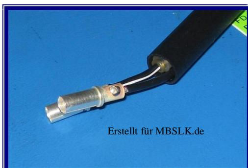
9. Die Steckerhülsen in das Gehäuse schieben und verklipsen.
