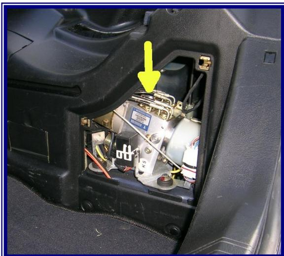
3. Hydrauliköl mit der Spritzflasche nachfüllen bis sich der Ölstand zwischen den beiden dreieckigen Markierungen befindet. Von MIN auf MAX sind es ca. 50 ml.
