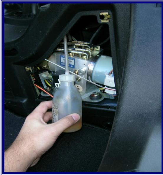
4. Öleinfüllschraube mit 8 Nm einschrauben.
