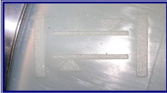
3. Zündung einschalten und den Heckdeckel schließen. Falls der Hydraulikölstand unter MIN ist muss Öl nachgefüllt werden.
