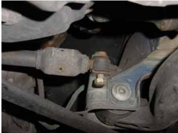
Der Dämpfer kann nun entfernt werden und gegen den neuen Dämpfer tauschen
