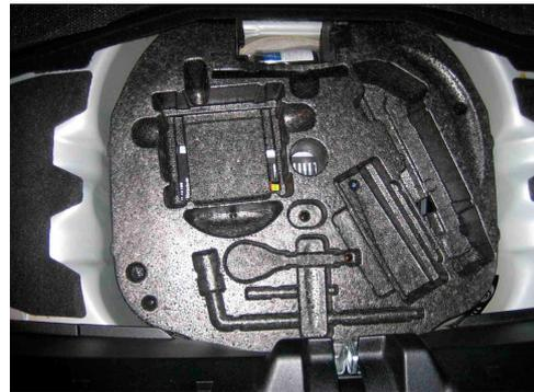
Ich habe einfach die Styroporschale mit Inhalt herausgenommen, den Blechboden unter der Schale mit einem zugeschnittenem Teppichboden ausgelegt, das Bordwerkzeug darauf gelegt und schön aneinandergereiht. Zusätzlich kann noch einiges an Werkzeug das man selber mit führt verstaut werden.
