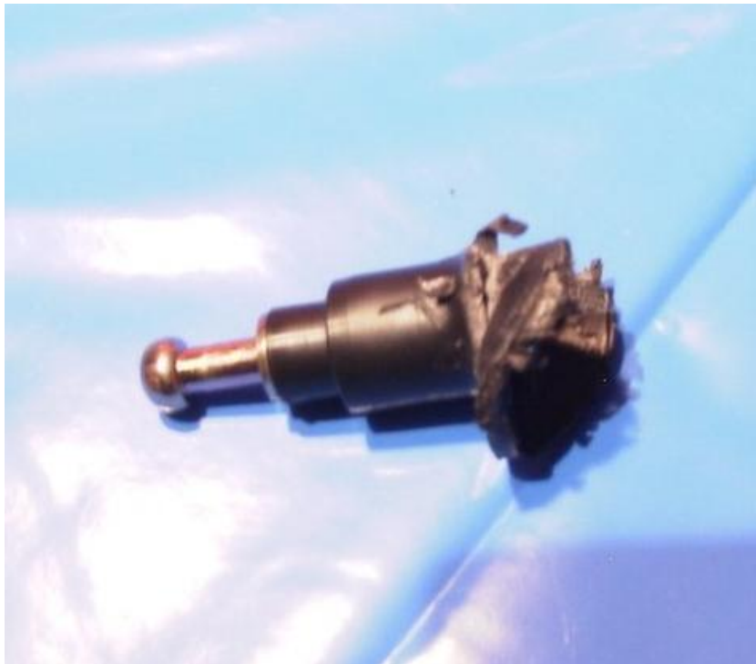
Im Bild das Plastikteil, das wir herausnehmen müssen. Dieses hier wurde mit einer Kombizange gepackt, herausgezogen und teilweise zerstört. Da es nicht mehr benötigt wird, spielt das jedoch keine Rolle.
