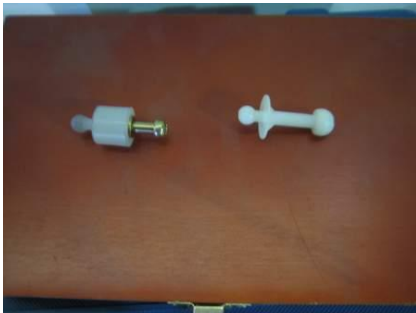
Links die Alternativlösung, rechts im Vergleich ein LWR-Gestänge aus dem Originalscheinwerfer.
