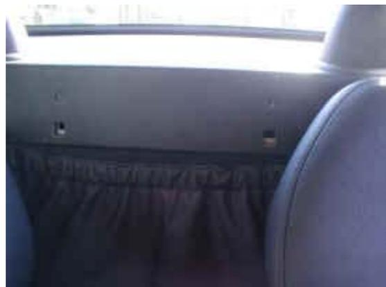
Setzen Sie bitte das Windschott an. Die zuvor entfernte Originalschraube führen Sie bitte in das oberer Loch ein und befestigen sie wieder mit dem Werkzeug.
