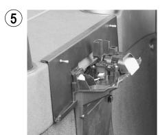
Schieben Sie die Metallplatte mit der Schraubenaufnahme zu Ihnen hin gerichtet hinter die Verkleidung und achten Sie auf die Verkabelung!
