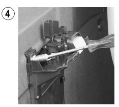
Lösen Sie anschließend die linke und die rechte Mutter ohne diese zu entfernen! Vor den Muttern können Lautsprecher des Sound-Systems sitzen.
