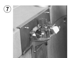
Jetzt ist die Halterung für das Windschott montiert.
