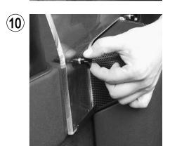
Drehen Sie zum Schluß die beiden Knebelschrauben **handfest** in die Gewinde um das Windschott zu fixieren.
