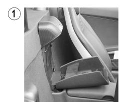
Öffnen Sie das Staufach an der hinteren Stirnwand zwischen den Sitzen.
