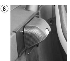
Schieben Sie anschließend die Kunststoffabdeckung wieder von oben an ihren Platz und befestigen Sie diese mit den bei Bild 2 erwähnten Schrauben.
