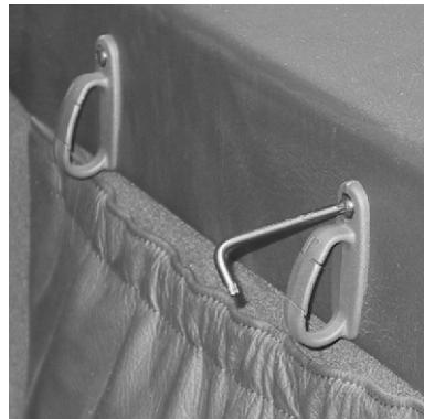
Lösen Sie mit dem beiliegenden Torxschlüssel die Schrauben der Karabinerhaken.
