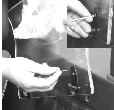
Durch das obere Loch der Metallplatte wird die Schraube des Karabinerhakens wieder angebracht und mit dem Torxschlüssel festgezogen.
