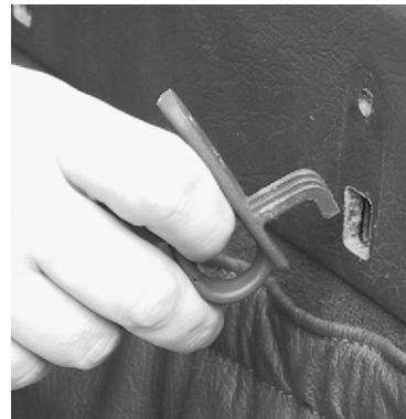
Nehmen Sie den Karabienerhaken durch Ziehen aus der Halterung.
