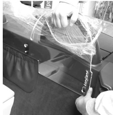
Zur Montage des Windschott gegen die Stirnwand drücken, gleichzeitig mit etwas Druck nach unten drücken.
