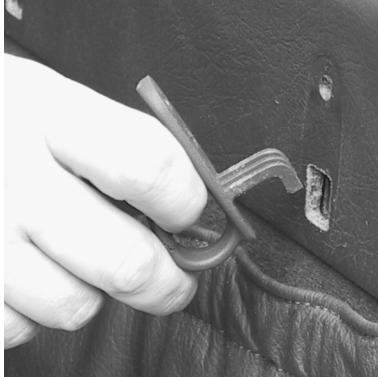
Nehmen Sie die Karabienerhaken durch Ziehen aus der Halterung (evtl. um 90° drehen).
