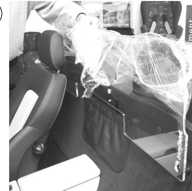
Schieben Sie das Windschott in seine Position. Lassen Sie die Folie im oberen Bereich am Windschott, damit es für die Montage besser geschützt ist.
