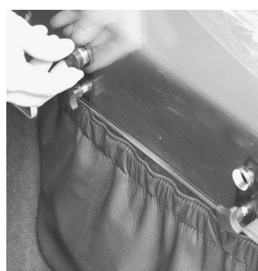
Durch die oberen Löcher des Windschotts können Sie nun die Schrauben mit dem Torxschlüssel richtig befestigen. Danach können Sie die Abdeckkappen aufstecken.
