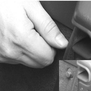
Sollte sich das Windschott nur schwer über die Kunststoffnippel schieben lassen, lösen sie diese um ca. 1 bis 2 Umdrehungen.
