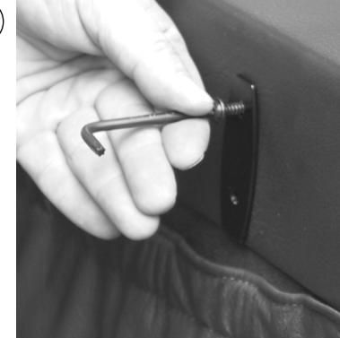
Befestigen Sie die beiliegende Metallplatte mit der Schraube des Karabinerhakens. Achten Sie darauf, dass das Loch mit dem Gewinde unten ist.
