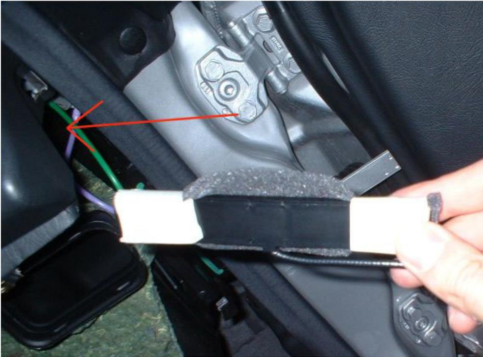
Abb. 11 zeigt einen Blick nach vorne auf den vorderen rechten Türanschlag: Die mit etwas Schaumstoff gegen Klappern geschützte GSM Antenne habe ich in Richtung der Markierung über dem links unten sichtbaren Luftauslass unter das Armaturenbrett geschoben. Um die Antenne zwischen der Windschutzscheibe und dem obenliegenden Luftschlitz im Armaturenbrett zu schieben, sind schmale Hände von Vorteil.
