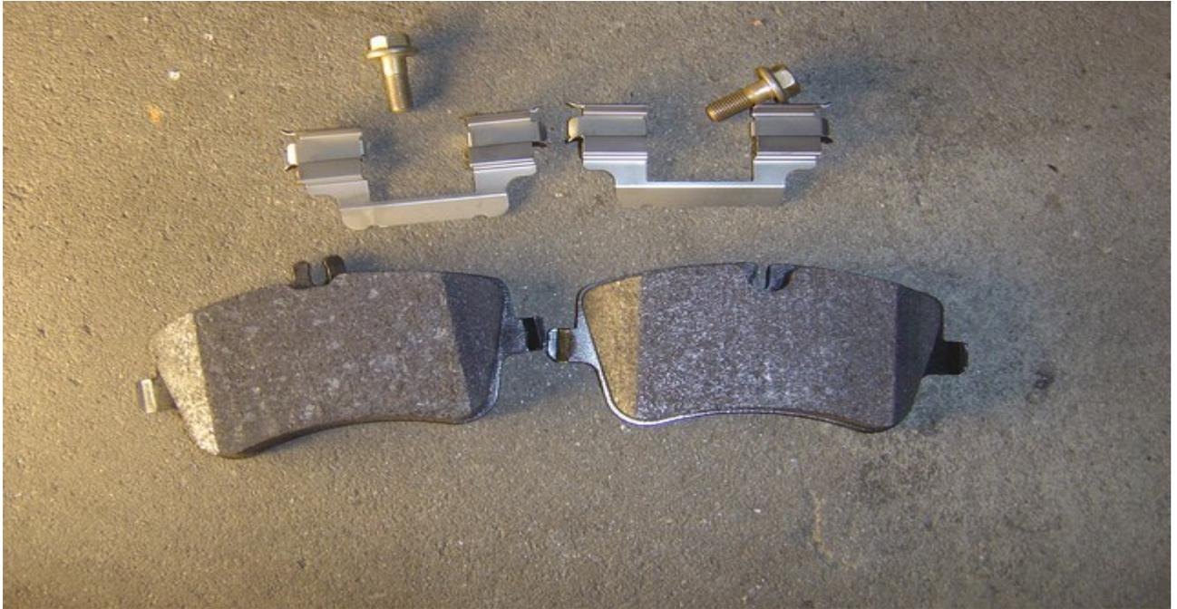
In den linken neuen Belag wird der neue Bremsbelagwarnkontakt von oben einfach rein gesteckt.
