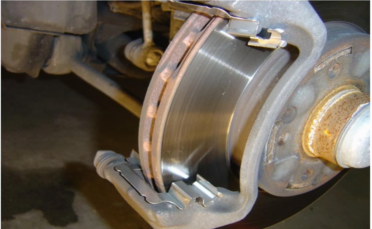
Jetzt werden die neuen Bremsbeläge in die Führungsnuten der Halteklammern eingeschoben. Darauf achten, dass sie gut an der Bremsscheibe anliegen! Die eine Seite der Beläge, die **nicht** an der Bremsscheibe anliegt, sollte man mit Kupfer- oder Keramikpaste dünn einschmieren, damit die Bremse später nicht anfängt zu quietschen.
