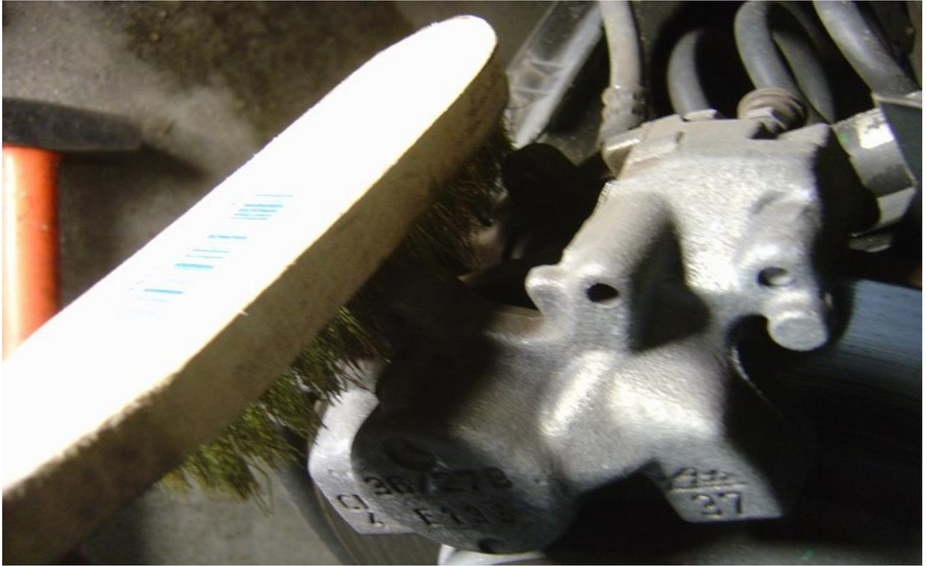
Anschließend die neuen Beläge (mit Kupferpaste behandelt) einfach in den Sattel reinschieben:
