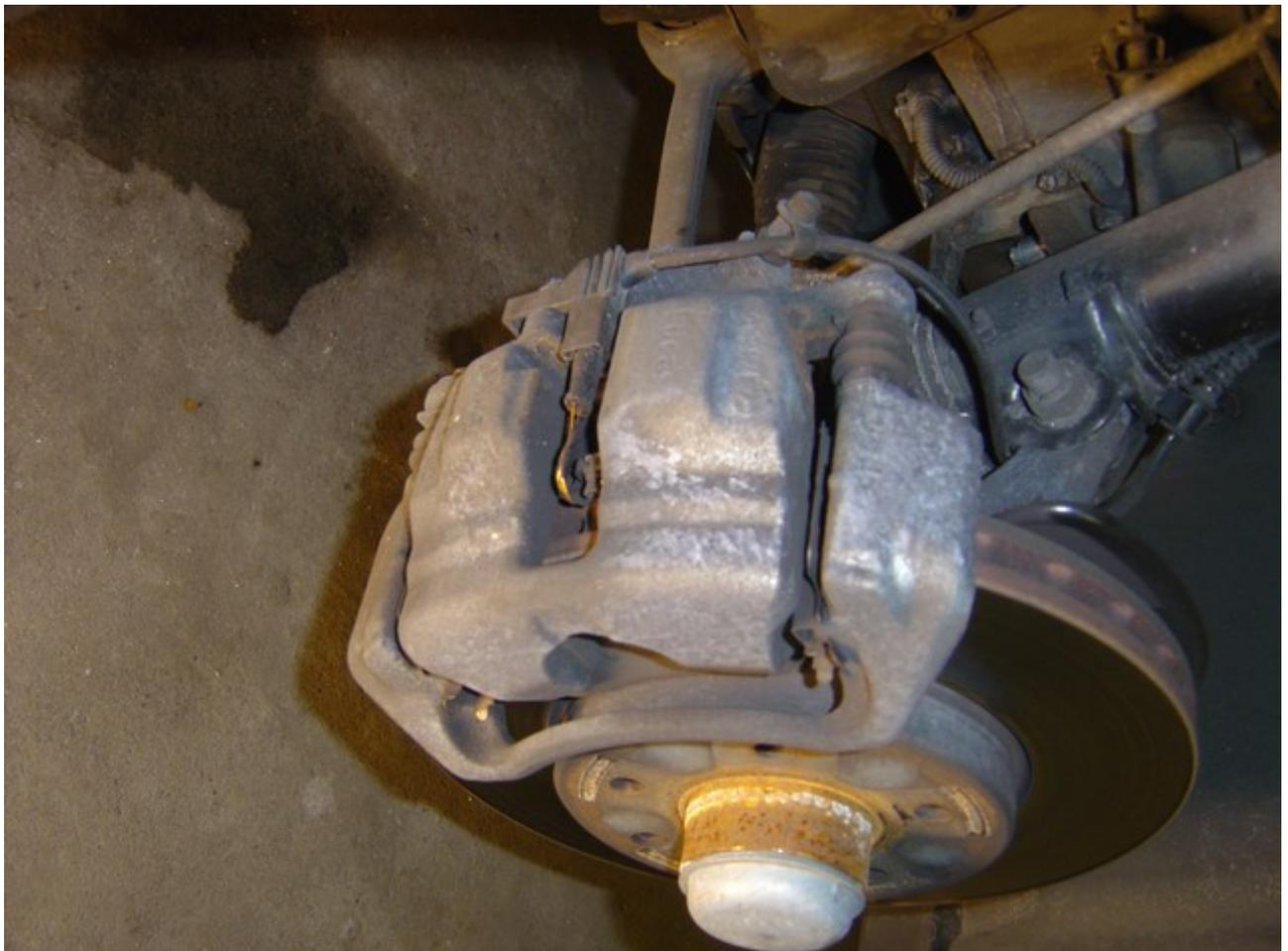
Hier eine Nahaufnahme wo man gut die Belagdicke erkennt und wo der Bremsbelagwarnkontakt sitzt - dieser hatte bereits ausgelöst und somit eine Warnung im Display generiert. (Bremszylinder schon zurückgedrückt)
