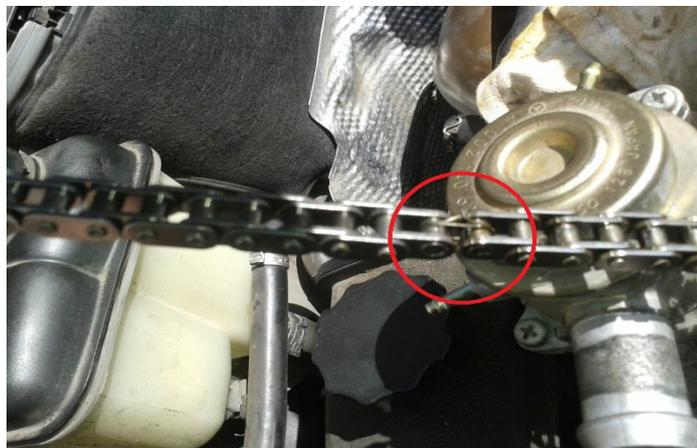
Nun die Kurbelwelle **entgegen des Uhrzeigersinnes drehen**, bis die neue Steuerkette komplett drin und die alte Kette raus ist. Dabei muss die neue und alte Steuerkette natürlich frei laufen und die Nockenwellen drehen sich nicht mit. Die Kurbelwelle muss zum Schluss wieder im O. T. des ersten Zylinders stehen. Nun die beiden Enden der neuen Steuerkette lose mit dem Blumendraht verbinden und auf den Nockenwellen Zahnradern ablegen.
