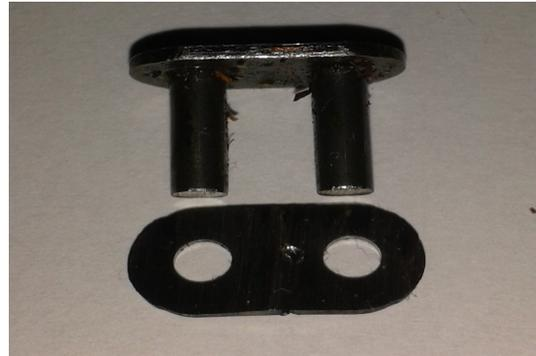
Nun verbindet man die Linke Seite der alten Ketten mittels Blumen Draht mit der neuen Steuerkette, die Rechte Seite wird mit Blumendraht irgendwo gesichert, damit sie nicht in den Kettenschacht fallen kann. Zum Einziehen der neuen Kette besorgt man sich am besten einen zweiten Mann.
