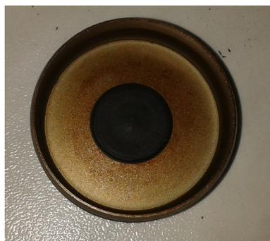
Ist der Deckel entfernt, den Kettenspanner mit einer 17er Langnuss herausdrehen.
