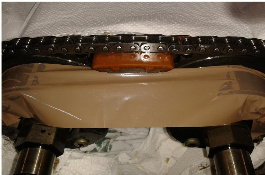
Die Ringschlüssel entfernen. Nun vorsichtig die Sicherungsclips auf die Bolzen schieben, mit einem feinen Schraubendreher aufschieben, bis es leise klickt, danach den korrekten Sitz der clipse überprüfen.
