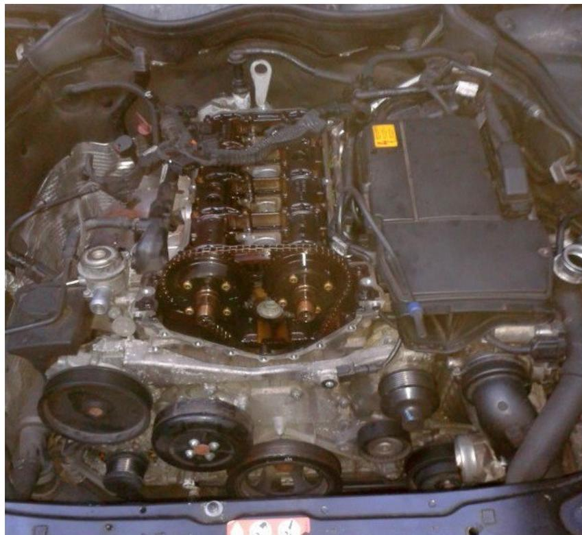
Den Motor mit der Ratsche und einer 27er Nuss am Kurbelwellenrad **im Uhrzeigersinn drehen**, bis die Markierung des Kurbelwellenrades bei Zylinder eins auf O.T. steht und die Markierungen der Nockenwellen mit denen auf dem Nockenwellen Halter fluchten.
