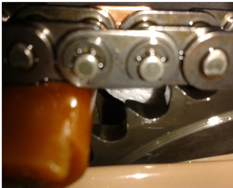
Nun den neuen Kettenspanner einschrauben, den Verschlussdeckel **jedoch** noch nicht einschlagen. Nun nehmen wir das Paketband und die Putzlappen wieder raus und drehen zur Kontrolle den Motor von Hand im Uhrzeigersinn ein paar Umdrehungen durch, und kontrollieren, ob die Steuerzeiten exakt stimmen. Sollten diese nicht stimmen, muss die Kette wieder geöffnet werden und das ganze wiederholt werden.
